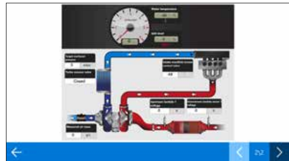
Sistema di dosaggio dell'agente riducente
